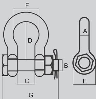
Material del cuerpo: Acero SAE 1040 forjado con tratamiento térmico
